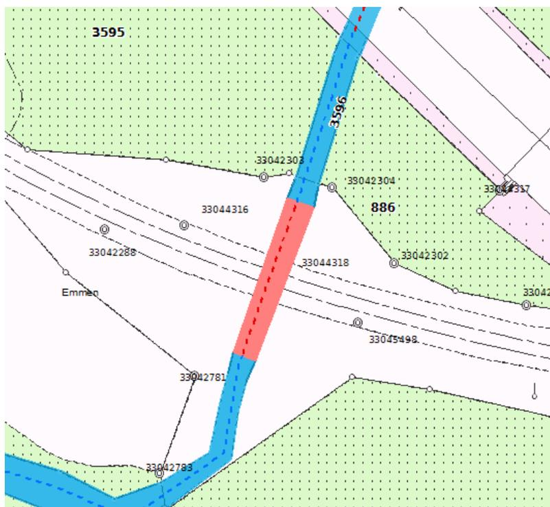
Abb. 4: Damm-Durchlass SBB (Ortbetonkanal) mit Damm Länge 45 Meter wird im GEWIS als unterirdisch klassiert.
